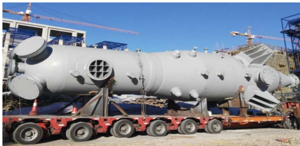
加氢气化400吨/天气流床气化炉
