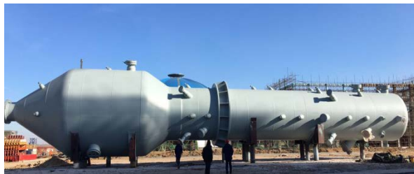
催化气化流化床气化炉
